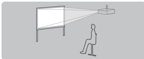
**Потолочная установка и проецирование сзади
