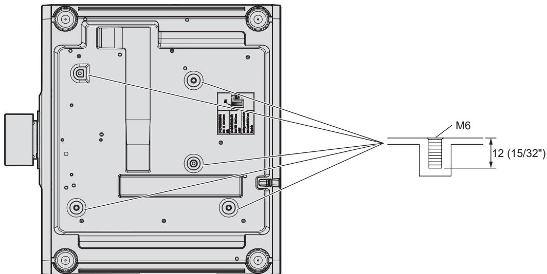
■ Размеры отверстий для винтов для крепления проектора (вид на нижнюю часть проектора)
