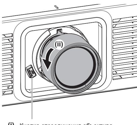
(i) Кнопка отсоединения объектива
