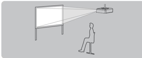
Крепление к потолку и проецирование сзади
