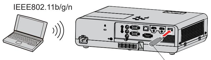
Беспроводной модуль из дополнительных принадлежностей
