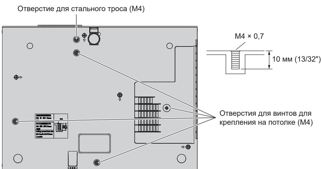
■ Размеры винтовых отверстий для крепления проектора (вид снизу проектора)
