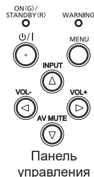
Входной сигнал для проецирования можно выбрать. Ниже представлен способ переключения входного сигнала.
