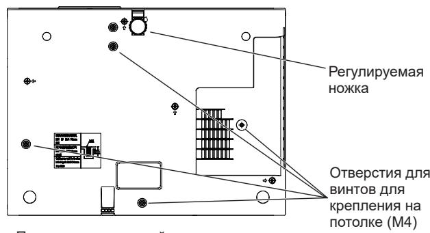
Положения отверстий для винтов для крепления на потолке и Регулируемая ножка
