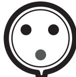
2P/3W 32 A 250 V Положение на 6 часов
